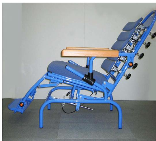
図3 試作イスにおける連動型リクライニング機構の稼働(座面 15度, 背もたれ 123度)
