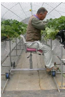
図 9 移動作業車が高設栽培ベンチ間で稼働している様子
