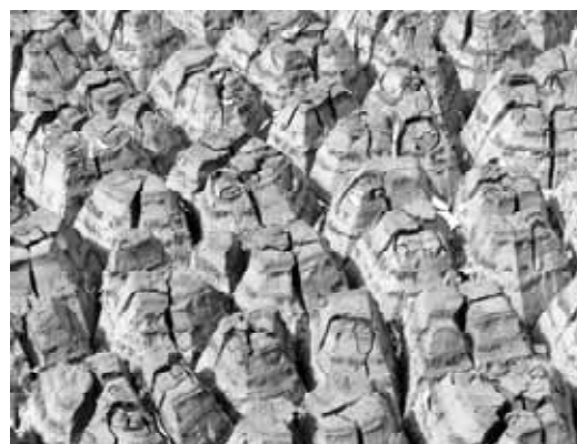
図 1 浄水場汚泥の発生状況（天日乾燥の様子）
