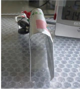
図2 曲げ試験 (R=10mm)
