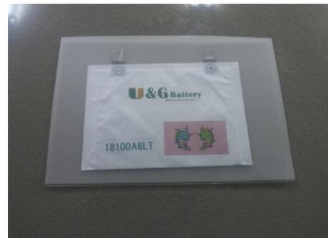
図1 実験に供したフレキシブルシート電池
