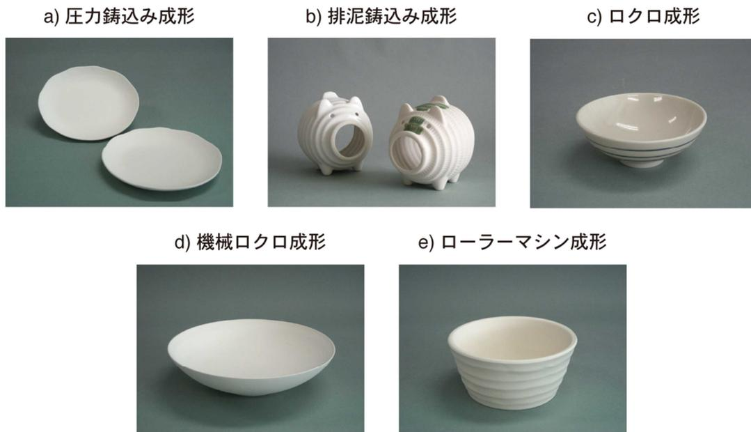
図 4 様々な方法で成形した成形体の写真 (a: 圧力鋳込み成形, b: 排泥鋳込み成形, c: ロクロ成形, d: 機械ロクロ成形, e: ローラーマシン成形)
