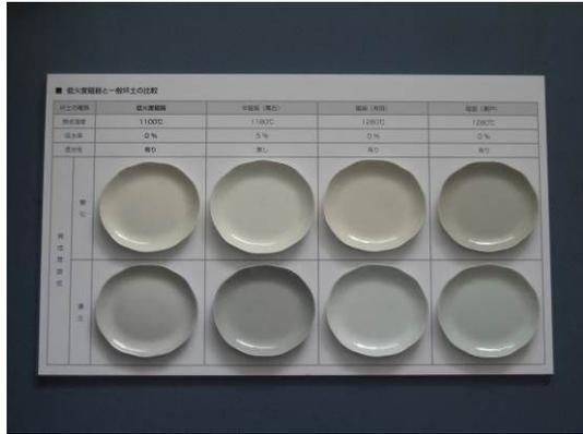
図2 低火度磁器土と一般坯土の比較
