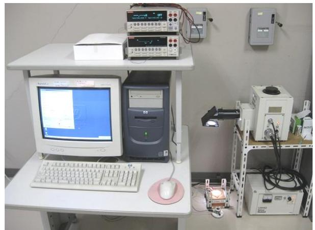
図 3 太陽電池評価装置
