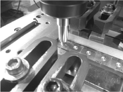
図1 摩擦攪拌接合装置
