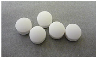
コーティングした錠剤(8mm φ, 200mg/錠) アセトアミノフェン(AAP)150mg/錠 TC-5RW : EUDRAGIT 混合比率 3:7 (コーティング量: 5.5%)
