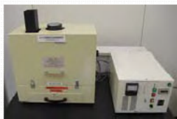
紫外線照射装置 光源: 1kW(80W/cm)高圧水銀ランプ
