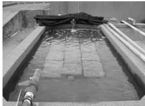
図 2. 石板を設置した実験水槽
