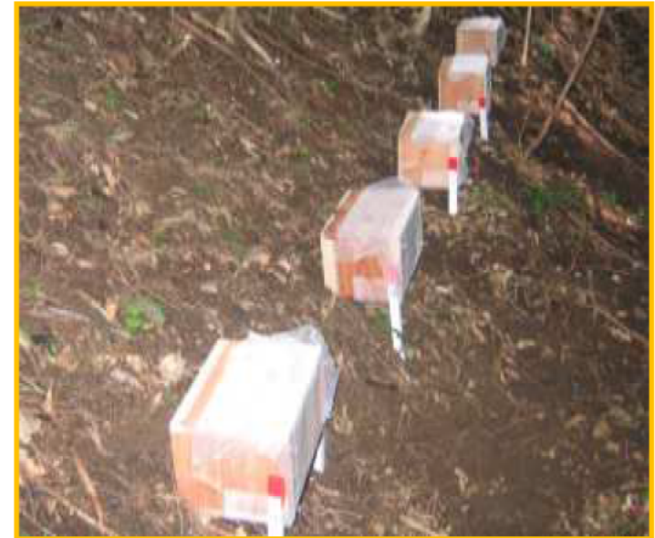
土砂受箱を設置し 土砂流出量を継続調査
