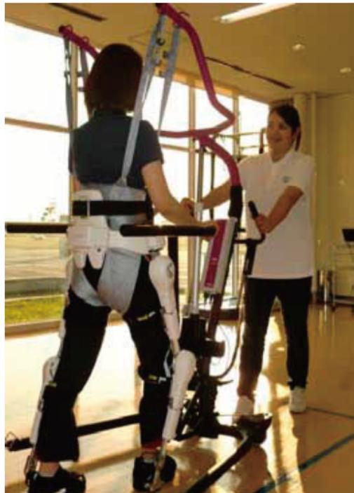
写真は、ロボットスーツ HAL<sup>®</sup>を使ったトレーニングの様子です。HAL<sup>®</sup>とは、人が体を動かそうとする際に脳から出る電気信号を読み取って、動作の支援をしてくれるロボットスーツのことです。国内約 160 施設で福祉用約 370 台が導入され、欧州を中心に医療用 100 台以上が活躍しています。鈴鹿ロボケアセンターは、脳血管障害や脊髄損傷などで足に障がいのある方や脚力の弱くなった方が、HAL<sup>®</sup>を使ってトレーニングを行うための施設として、平成 25 年 9 月にオープンしました。現在、鈴鹿市からは下肢・体幹機能障害 1 ~ 3 級の市民の方を対象に、トレーニング費用の一部助成を行っており、多くの方々が利用されています。
