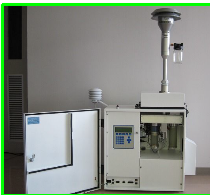
図 3 FRM-2025（標準法サンプラー） （自動連続サンプルング式）
