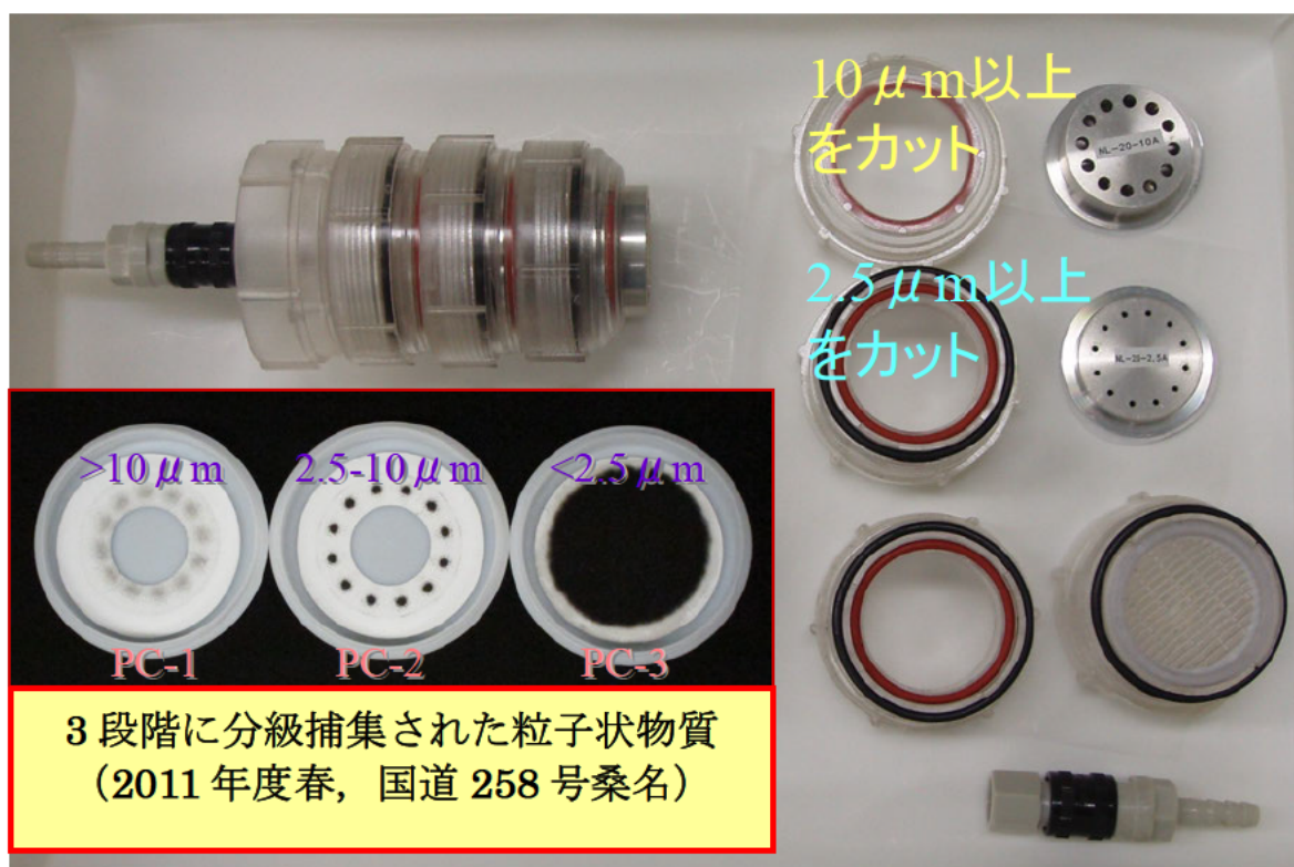
図5 PCI サンプラー（簡易法サンプラー）とろ紙（分級別）
