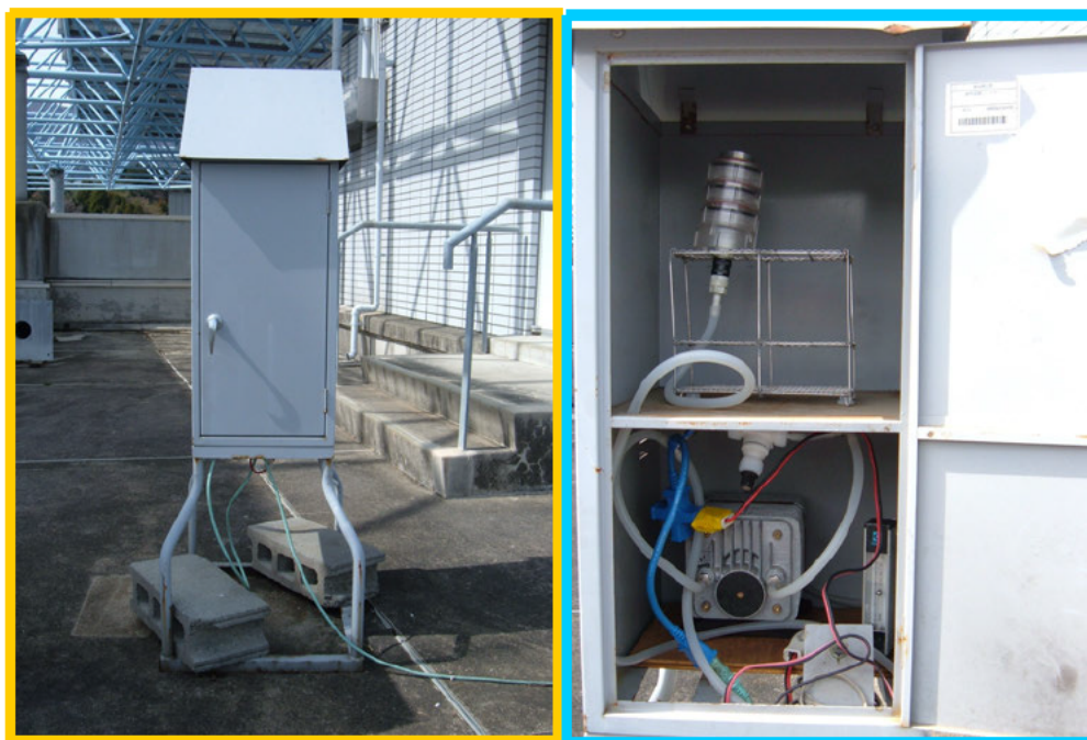
図4 PCI サンプラー（簡易法サンプラー）によるサンプリング
