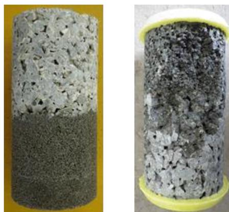
(b) コア供試体 (c) 破壊試験後の様子
