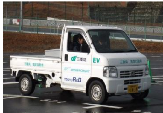
☆ コンバートEV(ホンダ・アクティ改造)
