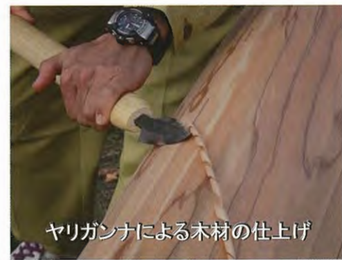
ヤリガンナによる木材の仕上げ ヤリガンナは、日本独自の大工道具で、現在使われている台鉋が普及する江戸時代まで一般に使われていました。
