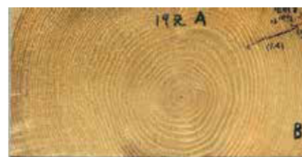
スケジュールB (軽G) (高温セット処理と中温低湿時に高周波併用)
