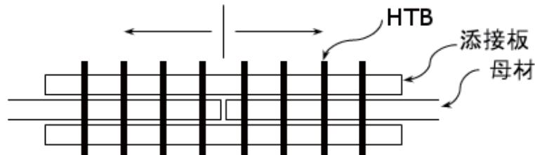
図3-3 ボルト締付け順序
