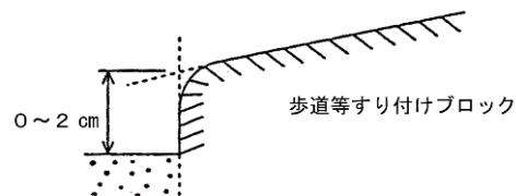
図3-1 縁石工(すり付けブロック)測定箇所
