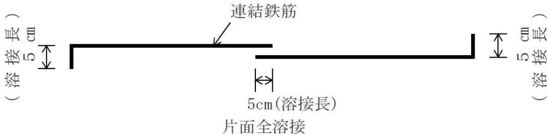
図3-9 コンクリートブロックの鉄筋継手
