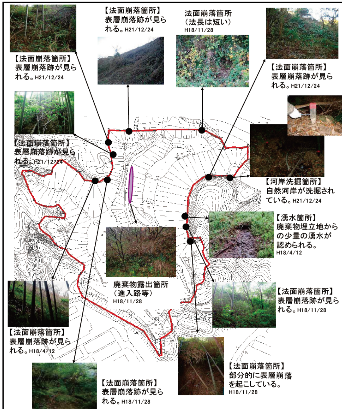
図2-15 法面崩落箇所状況図
