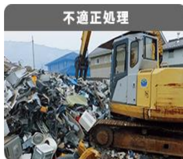
不適正処理 環境対策を行わずに廃家電を破壊することで、フロンガスや鉛などの有害物質が環境中に放出されます。
