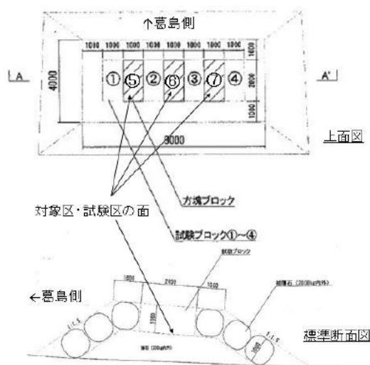
図 1. 人工藻礁の上面図および断面図
