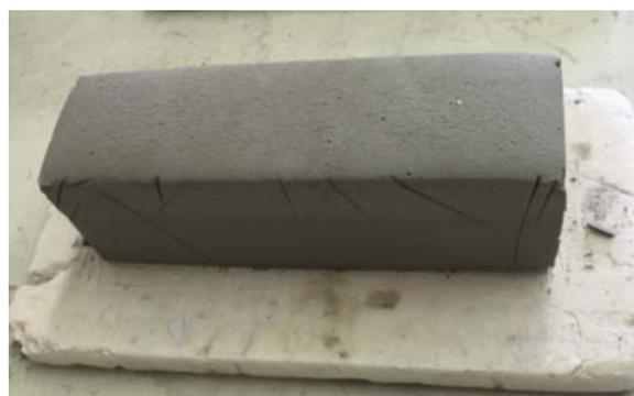
図 1 脱型後の発泡した供試体 (例)
