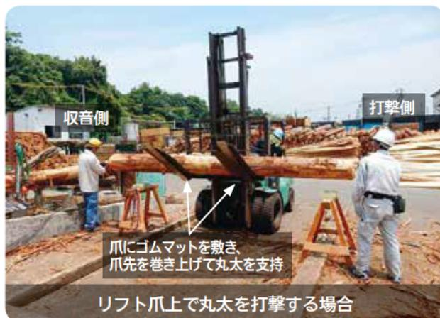
●上記で求めた材長、密度、共振周波数を用いて下式より縦振動ヤング率を求めます
