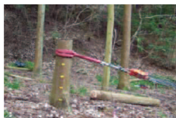
引き倒し試験による抵抗力調査
