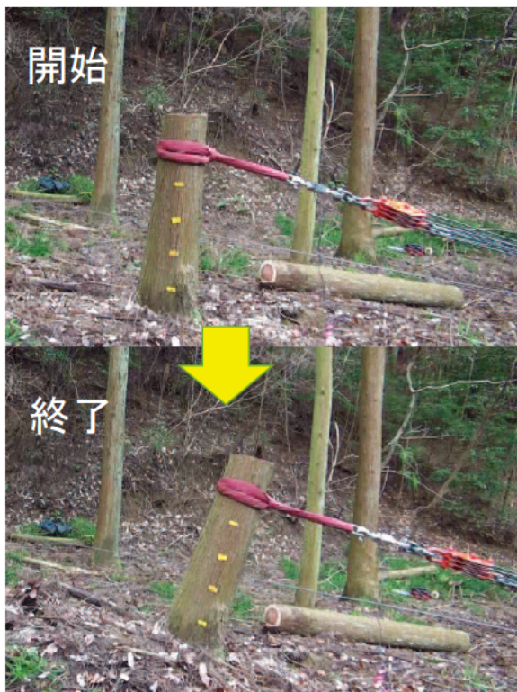
図9. 引き倒し試験の状況
