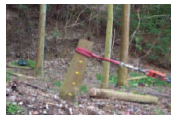
引き倒し試験による抵抗力調査
