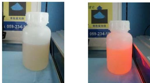
図 3 錯体蛍光体含有塗料の試作品 (左: UV 未照射 右: UV (365 nm 励起で赤色発光))
