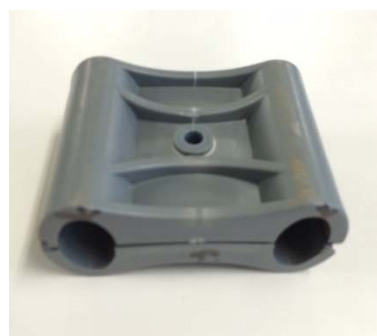
図 9 2面折り曲げ試験後の試験片 [図 6 中の試験片を裏返した状態、3点曲げにより背面リブの中心が白化している]
