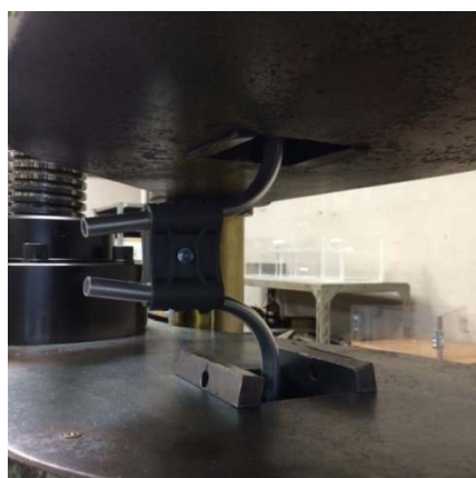
図 12 水平開き強度試験状況
