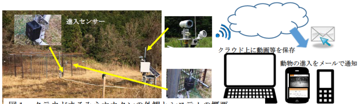
図1 クラウドまるみえホカクンの外観とシステムの概要
