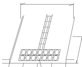
※出入口からの水平距離が150cm以上の水平面を確保するのが望ましい。
