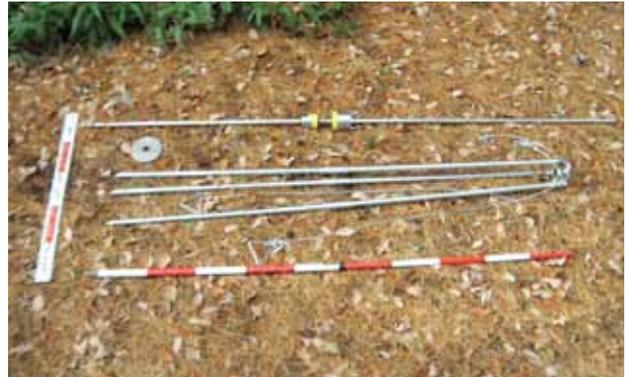
貫入試験装置一式。組立て後の運搬は、ハンマーが動くので指詰めに注意します。
