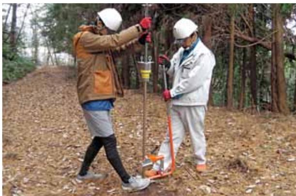
ロッドの引き抜きには、パイプ抜き器が有効です。試験後の穴を埋めて原形復旧します。
