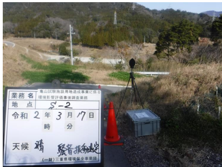
写真 1-5 騒音・振動調査状況 (S-2 : 令和2年3月17日)
