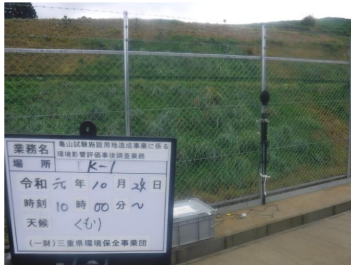
写真 1-1 騒音・振動調査状況 (K-1 : 令和元年 10 月 24 日)
