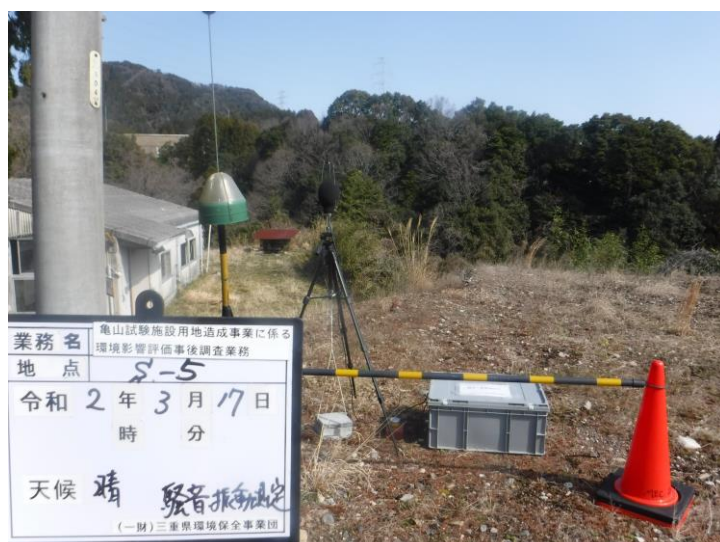
写真 1-6 騒音・振動調査状況 (S-5 : 令和2年3月17日)
