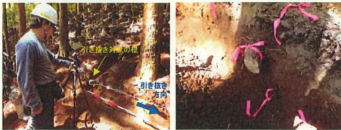
根系引き抜き試験の状況 引き抜き対象の根系 (ピンクテープ)
