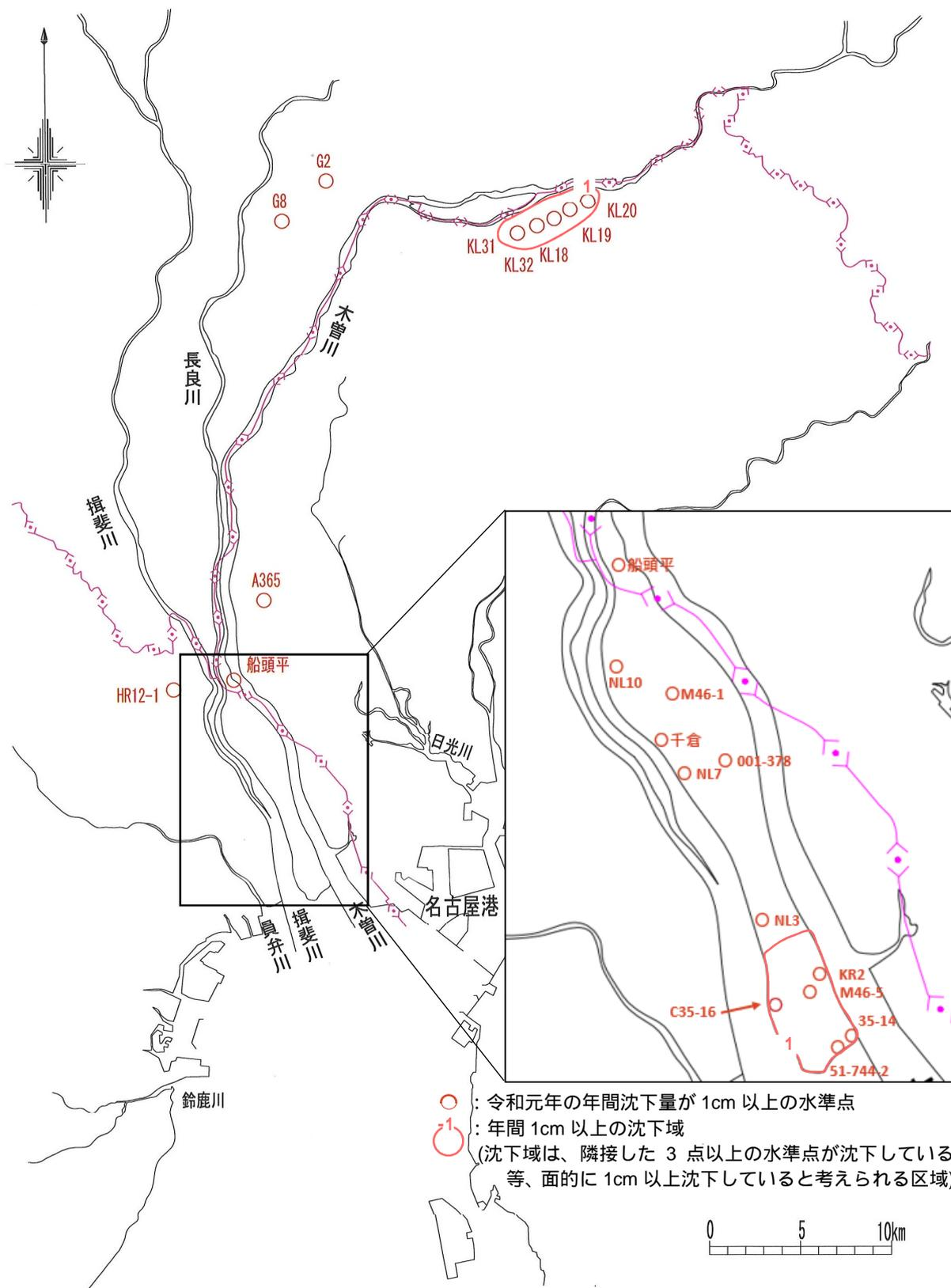
図 - 3 沈下域平面図
