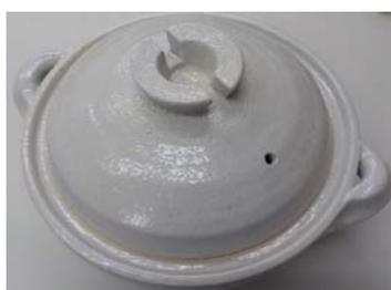
図 8 機械的強度を向上させて乳濁釉薬を施釉した土鍋試作品の外観
