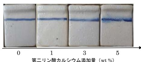
図 7 第二リン酸カルシウムを種々量添加した釉薬試験体の外観 (1180 °C)
