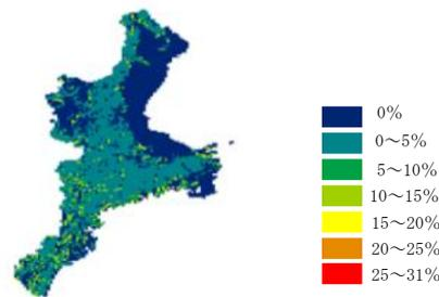
図28 斜面崩壊発生確率の上昇率（2081～2100年と1981～2000年との差）の予測
