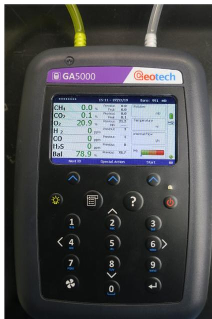
写真2 ガス検知器の一種であるポータブルガスアナライザー
