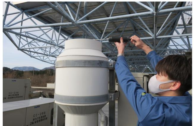
写真4 簡易試験法（検知管）を行う様子
