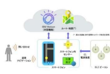
専用のアプリをスマホにダウンロードし、障がいの属性に応じて、目的地までナビゲーションしてくれるシステム。サンアリーナに設置されたシステムです。
