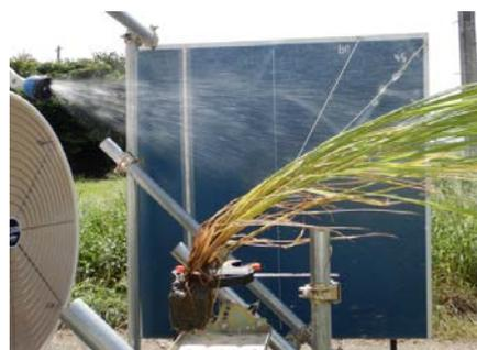
図1 人工台風発生機による耐倒伏性試験
