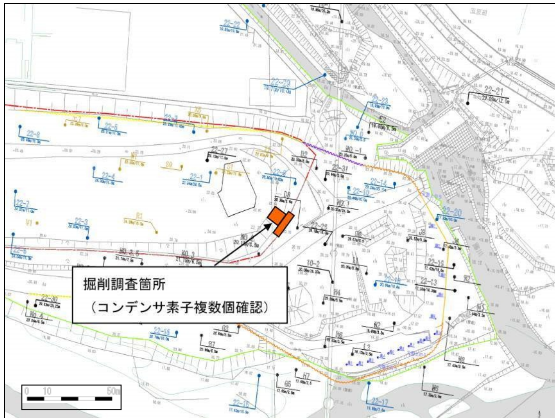
図 -5 PCB 汚染源掘削調査箇所
