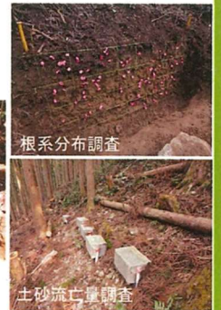
根引き抜き試験及び根系分布調査の実施、土砂流亡量の継続調査
