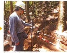
根引き抜き試験
