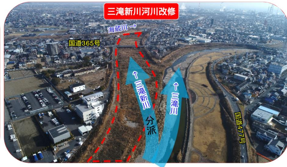
河道掘削、護岸整備による流下能力の向上
