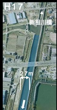
河口部から約900mの引堤完了
