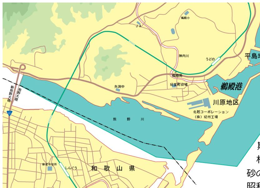
三重県の最南端の町、紀宝町に位置する鵜殿（うどの）港は新宮川（熊野川）左岸にある河口港で、江戸時代の文化年間に 1.2km 余の石堤が初めて築かれたことに始まります。明治 7 年（1874 年）には河口と港の防護工事を行いました。明治 22 年（1889 年）の大洪水で施設のすべてが流出しました。明治期には約 6 万 m<sup>2</sup> の水上貯木場が完成し、木材積出港としての性格を発揮しましたが、土砂の流入や、台風の影響に悩まされていました。昭和 46 年（1971 年）以降、港口部を海側に変更、製紙企業の原材料・石油類の搬入、製品の積み出し、地場産業である林産品や軽工業品の移出と漁業を含めた物流を目的とする大規模な改修事業を行いました。
