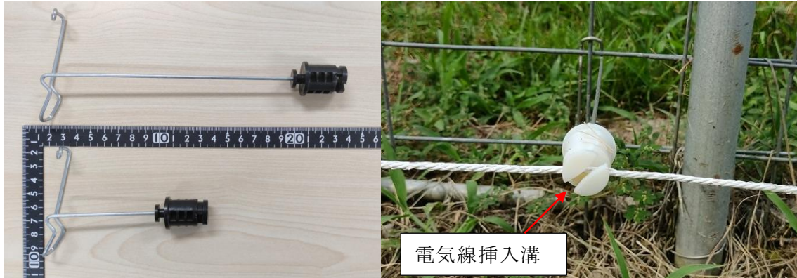
図1 ワイヤメッシュ用碍子概観（長さが約20cmと約10cmの2種類）とワイヤメッシュへ設置した状態
