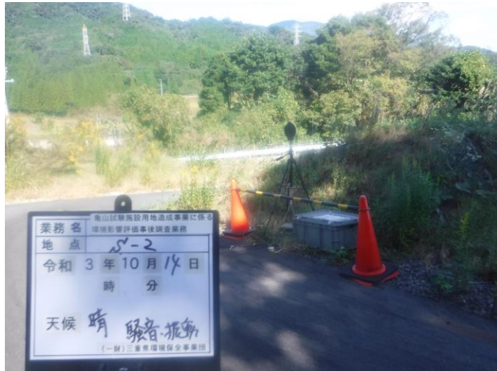
写真 1-5 騒音・振動調査状況 (S-2：令和 3 年 10 月 14 日)
