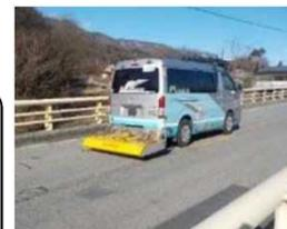
電磁波技術を利用した床版上面の損傷把握
