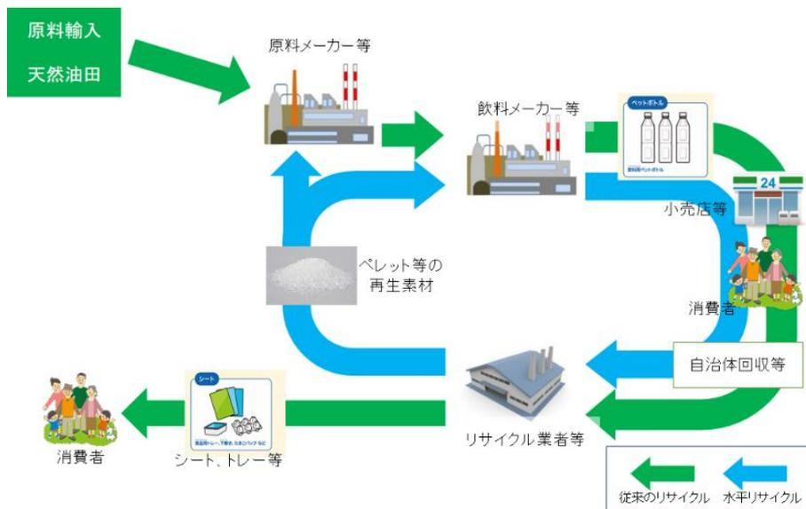
使い終わったペットボトルを原料として、再びペットボトルにする水平リサイクルを「ボトルtoボトル(ボトルtoボトル)」といいます。県内では、中部・西日本地区で初のボトルtoボトル原料の製造を一貫して行う工場が稼働しています。
