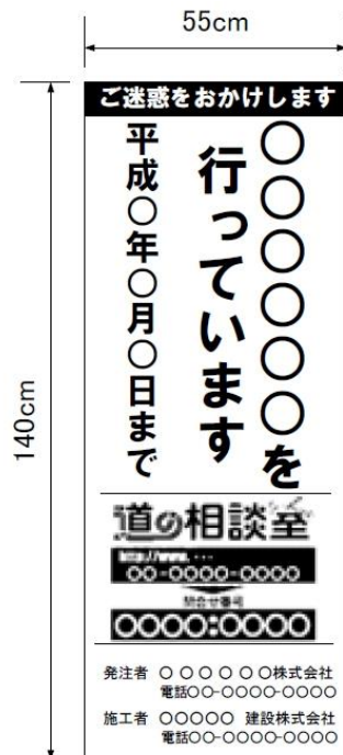
(様式4) 工事説明看板 (占用企業工事)
