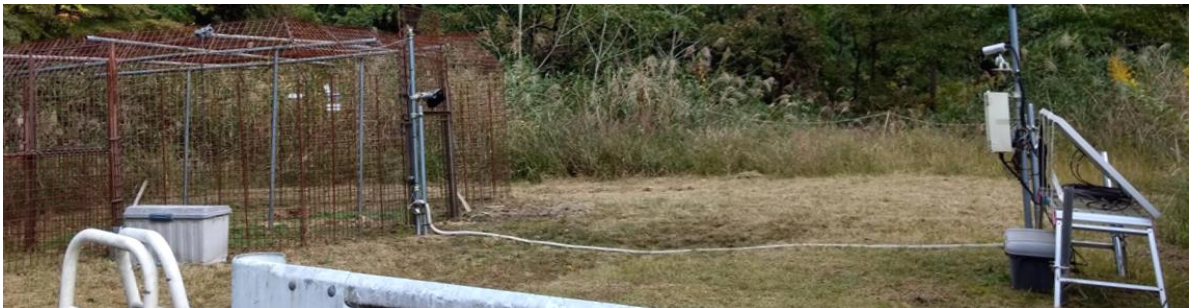
図1 大型檻・罾の遠隔監視・操作システム（webカメラにより檻内外をリアルタイムで監視し、檻周辺のサルが全頭檻内に入ったことを確認し、遠隔操作（スマートフォン、PC等）でゲートを落とす仕組み）
