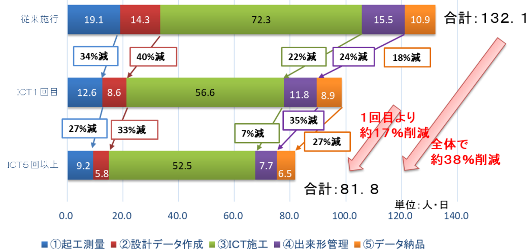
令和3年度の土工に係る延べ作業時間(ICT1回目22件、5回以上23件)
