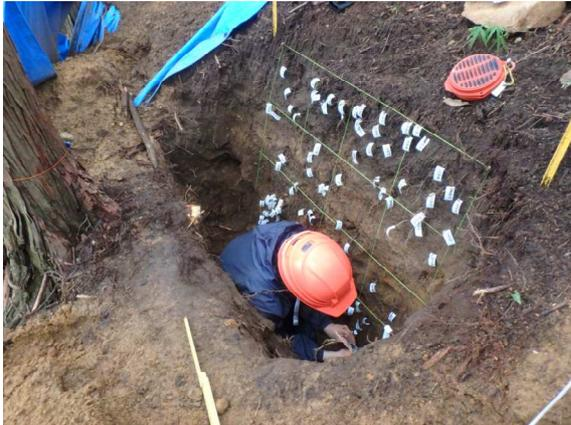
崩壊抵抗力を明らかにするための根系分布調査
